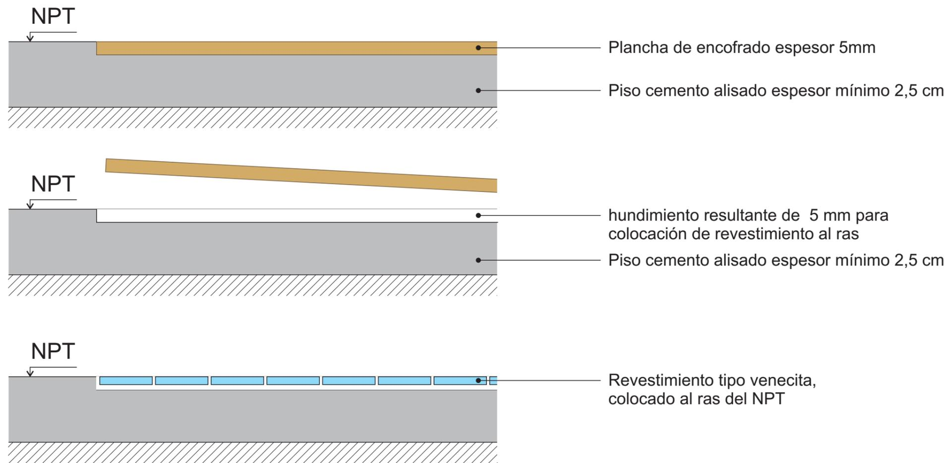
SE QUITARÁ EL ENCOFRADO DESINTEGRANDO POR CALOR (SOPLETE) Y CEPILLADO.
