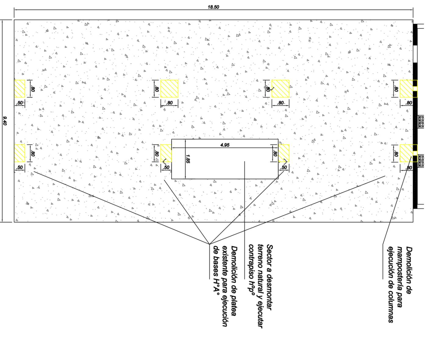
PLANTA DEMOLICIÓN ESC.: 1:100
